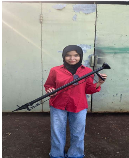
Gambar 4. Tampilan Alat Penabur Benih Jagung dari Samping
