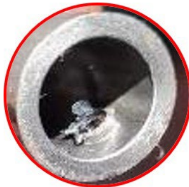
Gambar 3. Kondisi Burry pada Lubang Hasil Proses Drilling
