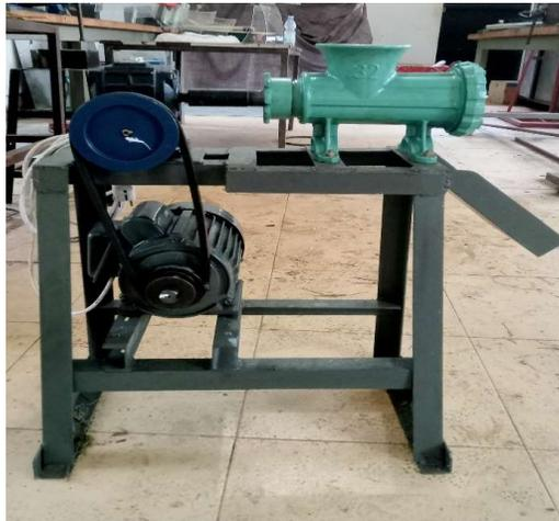
Gambar 4.2 Hasil Rancangan Mesin Penggiling Udang
