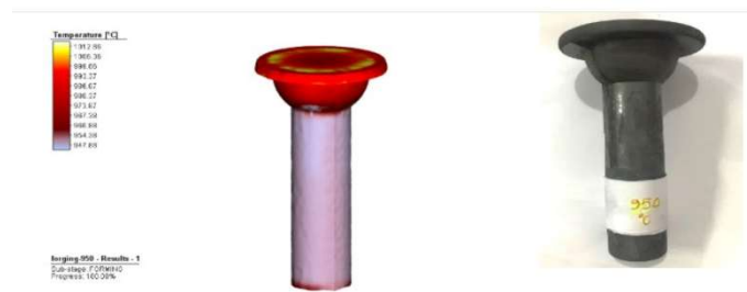
Gambar 1. Hasil dan Analisis Eksperimen pada (a) 1150 °C (b) 1100 °C (c) 1050 °C (d) 1000 °C (e) 950 °C
