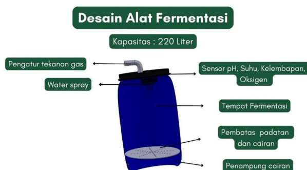
Gambar 2. Desain Alat Fermentasi Pokeener
