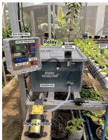
Gambar 4.2 Implementasi Peletakan Komponen Sistem pada Instalasi Hidroponik Drip Selada
