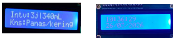
Gambar 4.7 Tampilan LCD pada kondisi normal
