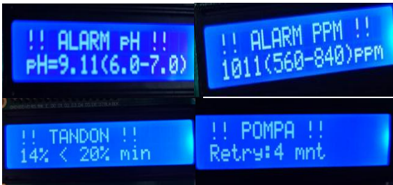
Gambar 4.8 Tampilan LCD Pada Kondisi Alarm Aktif
