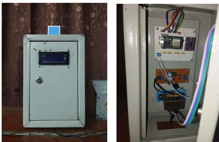
Gambar 4 Hasil Pembuatan Box Kontrol AC (Air Conditioner)
