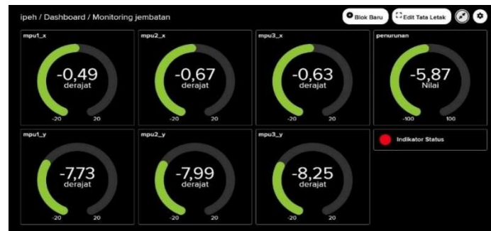
Gambar 7. Dashboard Adafruit IO kemiringan kanan (ekstrim)
