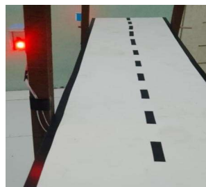
Gambar 8. Indikator lampu menyala saat kemiringan kanan
