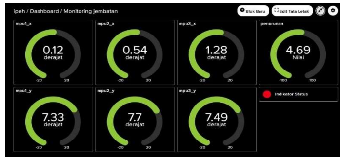
Gambar 10. Dashboard Adafruit IO kemiringan kiri (ekstrim)
