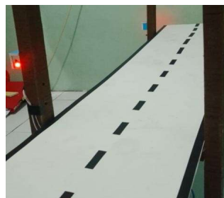
Gambar 11. Indikator lampu menyala saat kemiringan kiri
