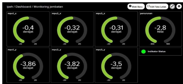
Gambar 6. Dashboard Adafruit IO kemiringan kanan (sedang)
