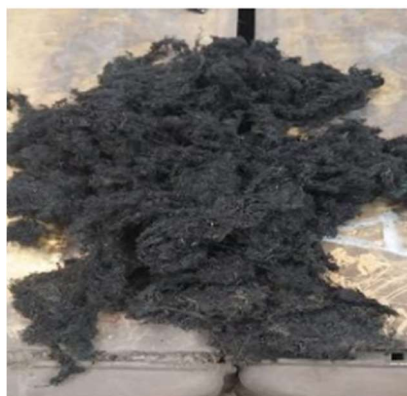
Gambar 4. Kontaminan Pada Komponen Air System
