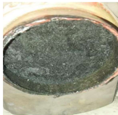
Gambar 3. Penyumbatan Pada Intercooler
