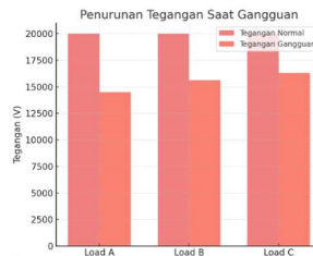
Gambar 13 Penurunan Tegangan Saat Gangguan
