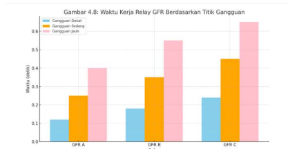
Gambar 17 Waktu Kerja Relay GFR Berdasarkan Titik Gangguan
