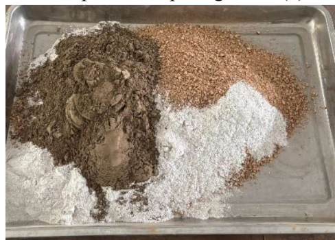
Gambar 3. Pencampuran Tanah, Fly ash , dan kapur
