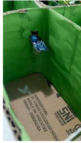
Gambar 13. Prototype Miniatur Ruangn Rumah dengan Penempatan Sensor MQ-2.
