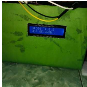
Gambar 18. Sensor SW-420 Mendeteksi Adanya Getaran.
