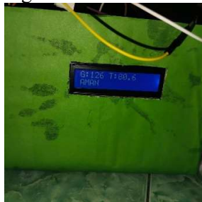
Gambar 19. Sensor GY-906 Mendeteksi Adanya Suhu Panas Tidak Wajar.
