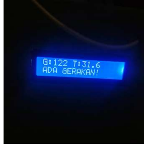
Gambar 20. Sensor PIR Mendeteksi Adanya Gerakan di Area Pintu.
