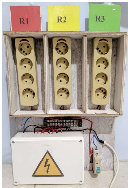
Gambar 3. Implementasi perangkat keras sistem kendali beban listrik
